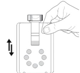
7. Öffnen Sie die obere Abdeckung des Integrated Nucleic Acid Testing Device, setzen Sie die SARS-CoV-2-Reaktionskarte gemäß der auf der Karte angegebenen Richtung in das Gerät ein, schieben Sie sie in die feste Position des unteren Kartensteckplatzes, und schließen Sie die obere Abdeckung.
